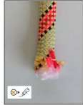
• Puna de cuerda dañada
